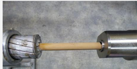
Collets CTC + Cubierta CTC + Núcleo cable ACCC®
