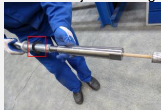
Espiga Inox + Cubierta CTC + Núcleo cable ACCC®
