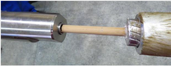
Collets CTC + Cubierta CTC + Núcleo cable ACCC®
